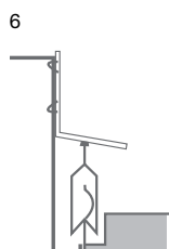
Perfilería para techo de placas metálicas Snap "T" with adjustable side supports Profil pour plafond en plaque métallique
